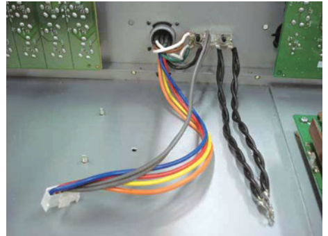
80 DCIN WIRING ASSEMBLY (DCIN束線)
